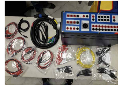
SIMULADOR TRIFÁSICO DE SISTEMAS DE POTENCIA PARA PRUEBA DE RELEVADORES Y ESQUEMAS DE PROTECCIÓN Marca: OMICRON Modelo: CMC - 356
