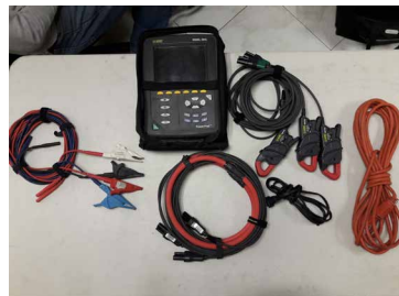
EQUIPO PARA ANÁLISIS DE CALIDAD DE LA POTENCIA Marca: AEMC Modelo: 8333
