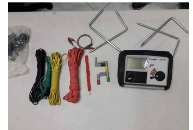
EQUIPO PARA MEDICIÓN DE RESISTENCIA DE TIERRAS Marca: MEGGER Modelo: DTR4
