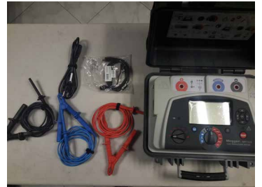
EQUIPO PARA PRUEBA DE RESISTENCIA DE AISLAMIENTO DE EQUIPOS DE POTENCIA Marca: MEGGER Modelo: MIT1525
