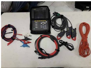
EQUIPO PARA ANÁLISIS DE CALIDAD DE LA POTENCIA Marca: AEMC Modelo: 3945
