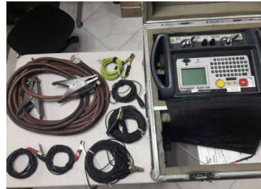
EQUIPO PARA PRUEBA DE RESISTENCIA DE CONTACTO DE INTERRUPTORES Marca: MEGGER Modelo: DLRO200
