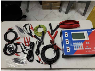
EQUIPO PARA PRUEBA DE SATURACIÓN DE NUCLEO DE TRANSFORMADORES DE CORRIENTE Marca: OMICRON Modelo: OCT ANALYZER
