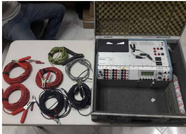
EQUIPO PARA PRUEBA DE TIEMPOS DE OPERACIÓN DE APERTURA Y CIERRE DE INTERRUPTORES Marca: PROGRAMMA Modelo: TM - 1600
