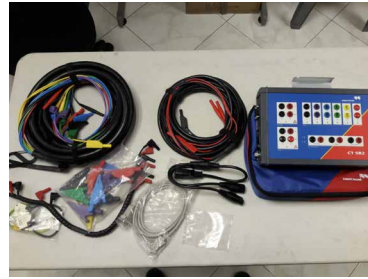
EQUIPO PARA PRUEBA DE SATURACIÓN DE NUCLEO DE TRANSFORMADORES DE CORRIENTE DE MULTIRELACIÓN Marca: OMICRON Modelo: OCT - SB2
